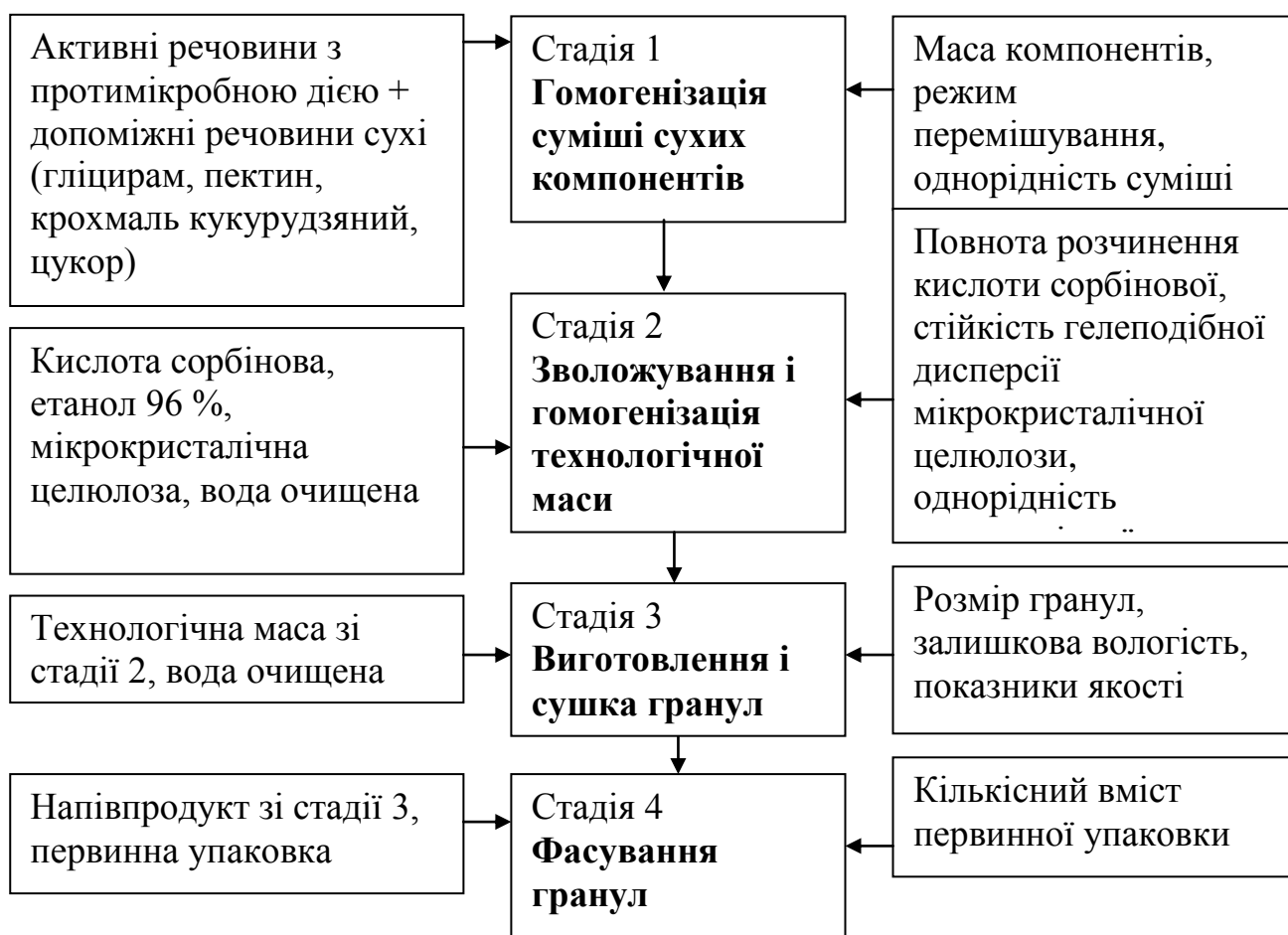
Рис. 1. Схема алгоритму технологічного виготовлення гранул нових протимікробних композицій.
